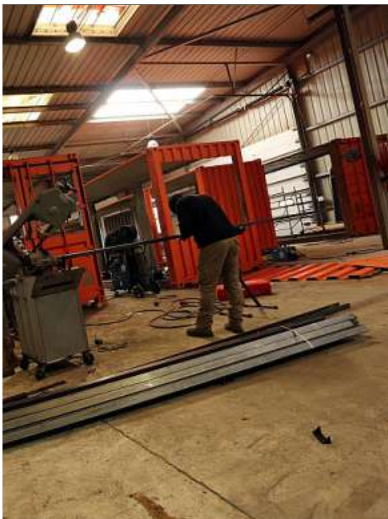
Une fois que ces caisses métalliques sont désossées, des encadrements sont créés pour accueillir les menuiseries.
